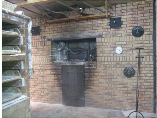
Juste derrière cette pièce, l'atelier proprement dit où sont confectionnés les quelques 16 variétés de pains et 4 sortes de brioches de notre boulanger. Le four, qui fonctionne grâce à la chaleur de la combustion du bois, est en brique et en sable. Son inertie thermique permet de le garder suffisamment chaud pour plusieurs tournées de pain.
